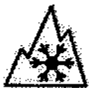
Рисунок 5.1. Маркировка, наносимая на зимнюю шину
